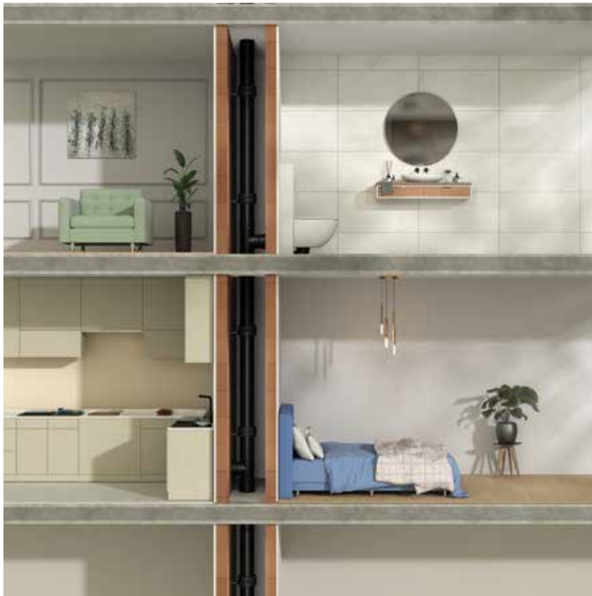
Izometrijski prikaz sustava odvodnje u višekatnici
